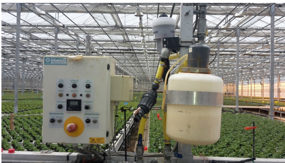
Figur 24. Foto: Niels Enggaard Klausen Montering af dunk på væksthussprøjtebom med Dosatron
