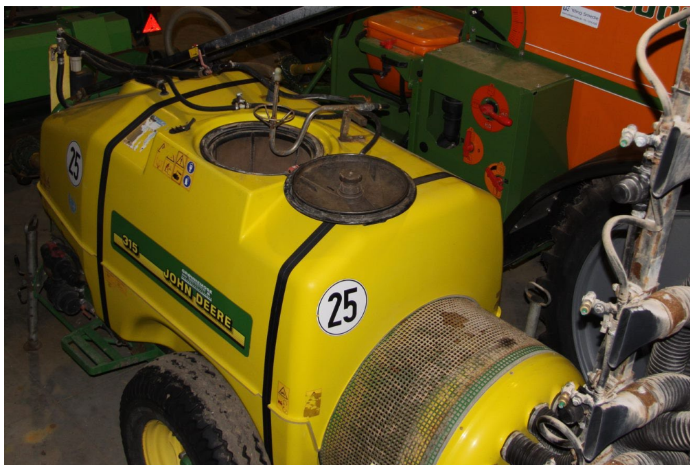
Figur 6. Foto: Niels Enggaard Klausen Tågesprøjte med montering af beholder til skylning af tom emballage. Dunkspuledyse i brugsstilling.
