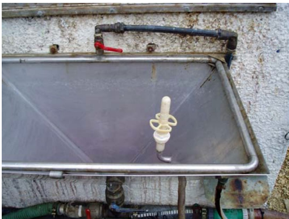
Figur 22. Foto: Poul Henning Petersen Fastmonteret præparatfyld, hvorfra pesticiderne suges op i sprøjtetanken. Enheden er udstyret med spuledyse til tomme beholdere.
