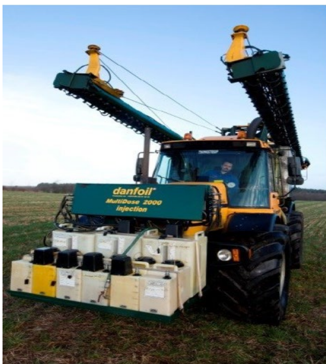
Figur 11. Foto: Niels Enggaard Klausen Marksprøjte med injektionssystem
