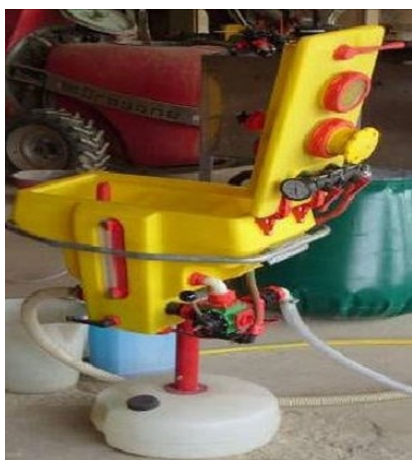
Figur 4. Foto: Topps Præparatfyldeudstyr, hvorfra pesticiderne suges op i sprøjten
