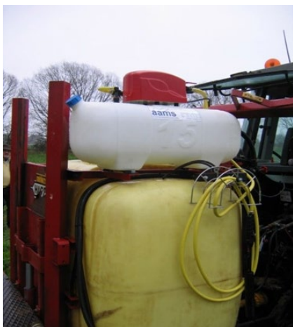
Figur 8 Foto: Niels Enggaard Klausen Rengøringsæt med rentvandstank, spuledyse og rengøringslanse til eftermontering
